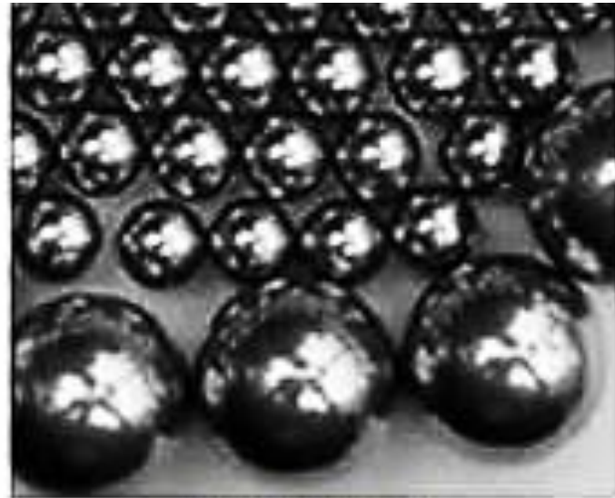
Вольфрам – найтугоплавкіший метал ( T_{\text{пл}} = 3420^{\circ}\text{C} )
