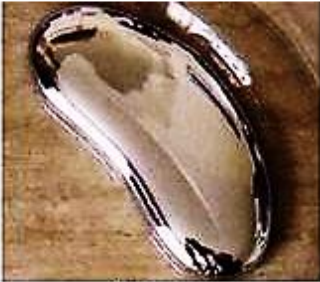
Ртуть – найлегкоплавкіший метал ( T_{\text{пл}} = -38,9^{\circ}\text{C} )
